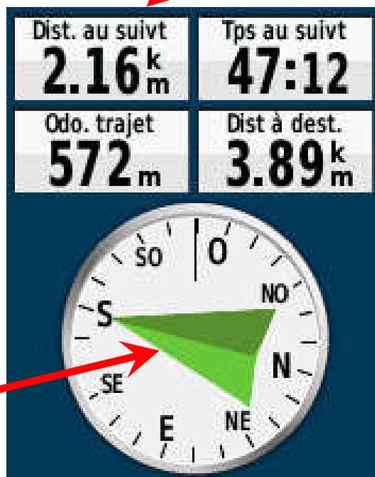
La *distance au suivant* fait référence au *point plus haut* ou *plus bas* suivant, si l'Etrex 30 a pu en déterminer.
